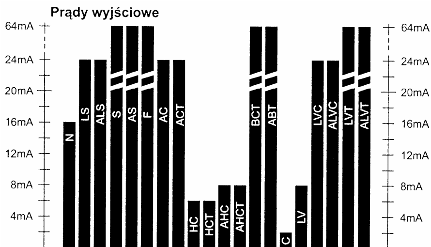
Rys. 1.17. Porównanie czasów propagacji i prądów wyjściowych w układach 74xx. T1-25
