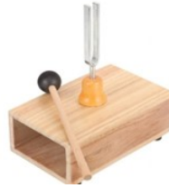
Rysunek 1. Kamerton stroikowy ustawiony na tzw. pudle rezonansowym wraz z wyposażeniem w postaci młoteczka Źródło: opracowanie własne.
