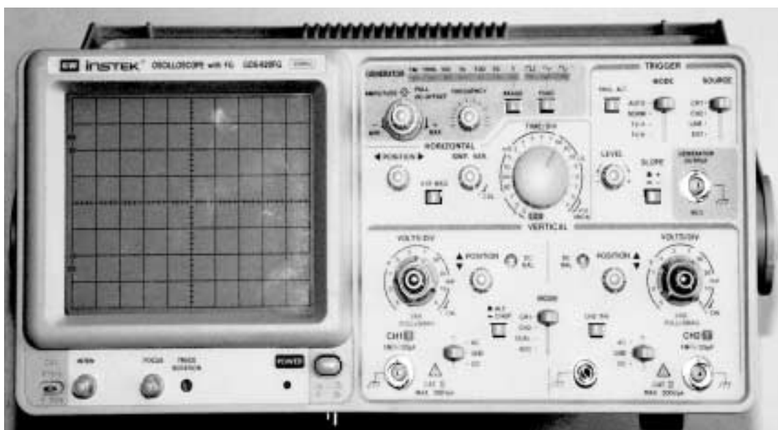
Rys. 3.58. Dwukanałowy, cyfrowy oscyloskop z wbudowanym generatorem funkcyjnym – INSTEK –GOS- 620 FG
