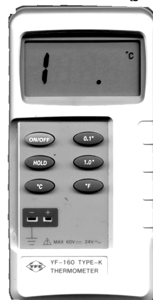
Rys.3.13. Elektroniczny termometr wykorzystujący czujnik termoparowy
